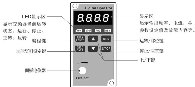
图4-1 操作面板示意图
