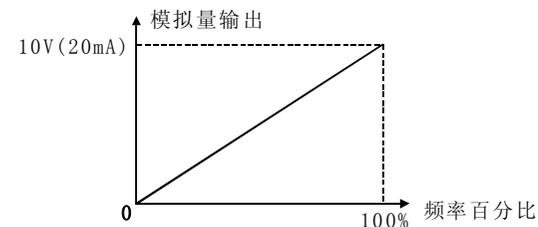
图6-13 给定量与模拟量输出的对应关系
