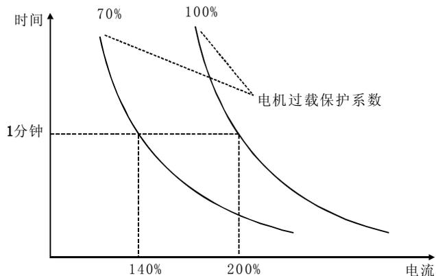
图6-21 电机过载保护系数设定
