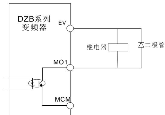
图3-8 数字输出端子接线示意图
