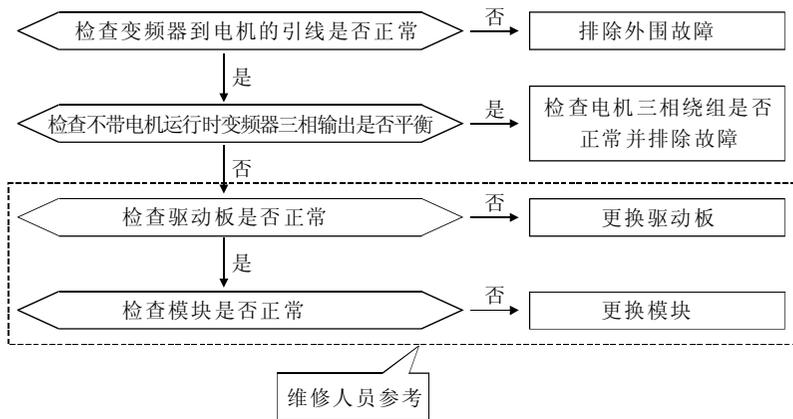
十五、电流检测故障保护 (E015)
