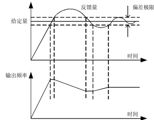
图6-19 偏差极限与输出频率的对应关系
