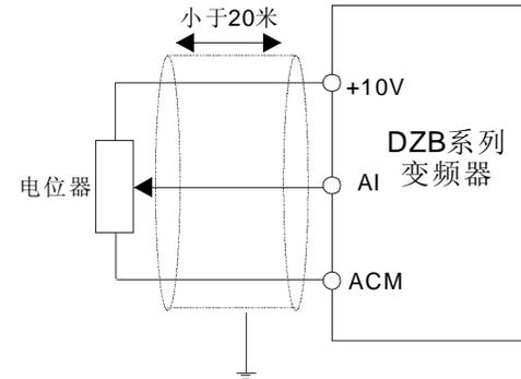
图3-6模拟输入端子接线示意图
