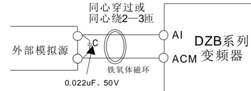
图3-7 模拟输入端子加滤波处理接线图
