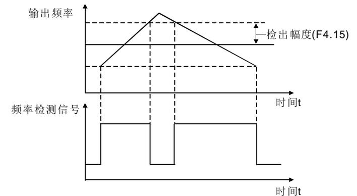
图6-17 频率到达检出幅值示意图
