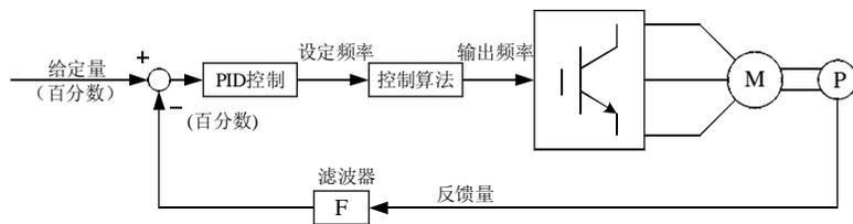
图6-18 过程PID原理框图
