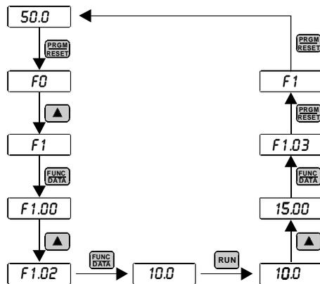
图4-3 参数编辑操作示例
