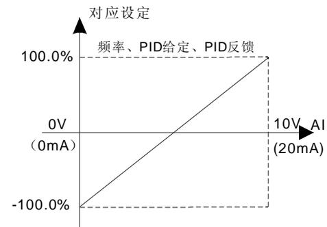
图6-12 模拟给定与设定量的对应关系
