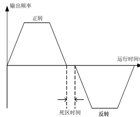
图6-4 正反转死区时间示意图
